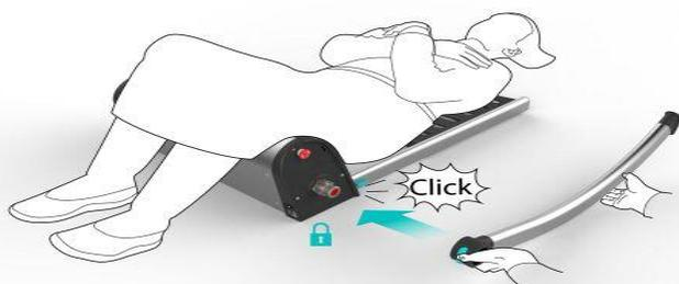
Faites glisser le pied de devant du Raizer (marqué en rouge pour le côté gauche) dans le siège jusqu'au clic. Notez que le mécanisme de blocage doit être du côté extérieur.
